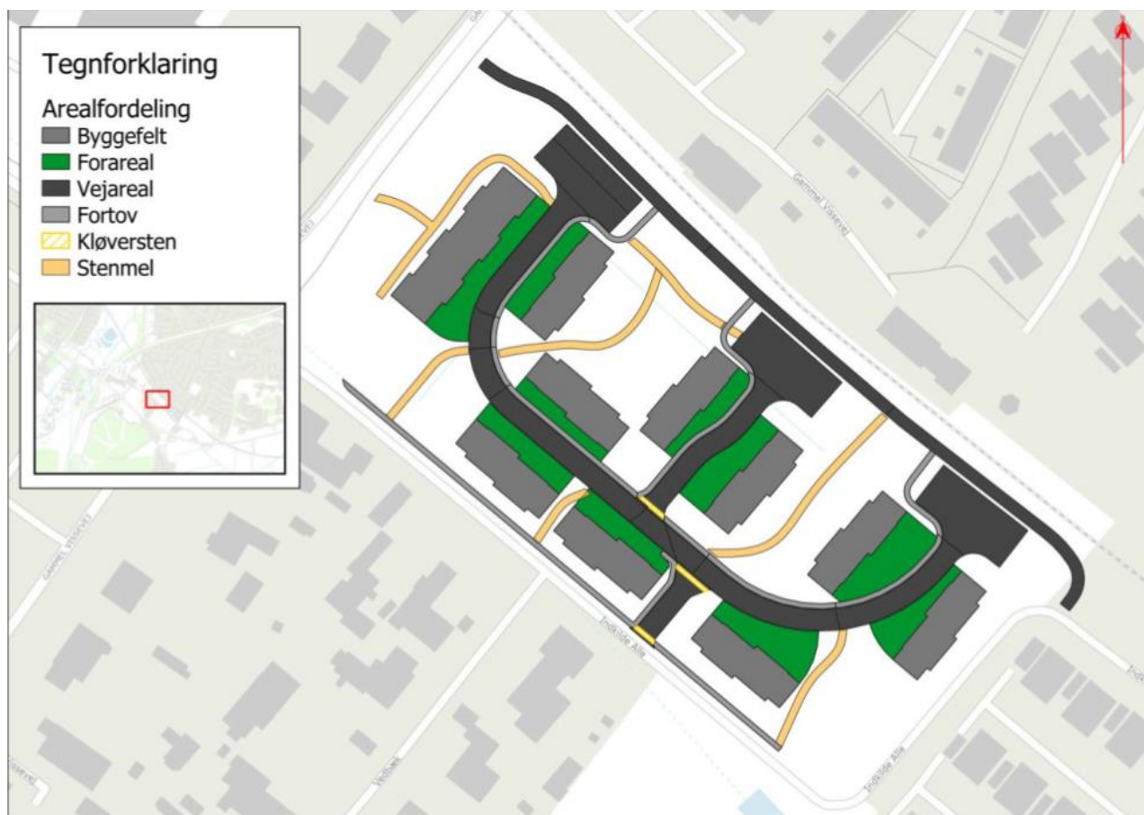
Figur 3: Oplandsinddeling af byggemodningen. Oplande, som ikke er markeret, regnes for grønne arealer uden bidrag til regnvandssystemet.
